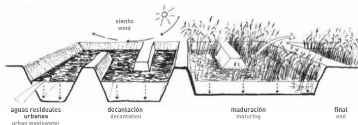
fijos o libres, permite la degradación de la materia orgánica o la reducción del nitrógeno hasta niveles tolerables. Estas técnicas, ayudadas con los pretratamientos adecuados, permiten obtener los niveles de calidad exigidos y, con los diseños adecuados, logran una muy buena integración en el entorno.
